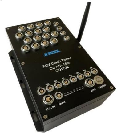
燃料汽车碰撞数采 CDAS-16S 按 ECE R134 中对氢燃料汽车碰撞试验要求进行设计。试验过工程可通过 WiFi 实时查看数据，监测碰撞安全性。其 8 路数字量输入可与瓶阀状态传感器 SM-05D 连接，通过霍尔电流传感器隔离监测瓶阀状态。CDAS-16S 支持外部开关触发，及内部加速度传感器触发。设备与车辆储氢系统连接时，需要通过三通线缆，串接到车辆压力和温度传感器接口。同时设备支持氢气浓度传感器 H2-5B（氦气浓度传感器 He-5B）的 RS485 连接。设备内置锂电池，支持 1HZ 数据记录及 Ethernet 数据通讯功能，数据提供 EXCEL 格式。
