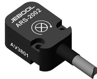
角速度传感器 ARS-2002 基于谐振器陀螺仪原理，内部包含多个振动构架，当检测结构旋转时，产生的科氏力来改变一个电容结构，进而转换为电信号变化，从而实现了角速度测量。独立的供电与测量系统完全隔离，直接输出电压信号与被测电流有较好的线性关系。ARS-2002 配有高性能耐磨线缆。另外，可以根据客户需要，配好 Dallas ID 和接头。
